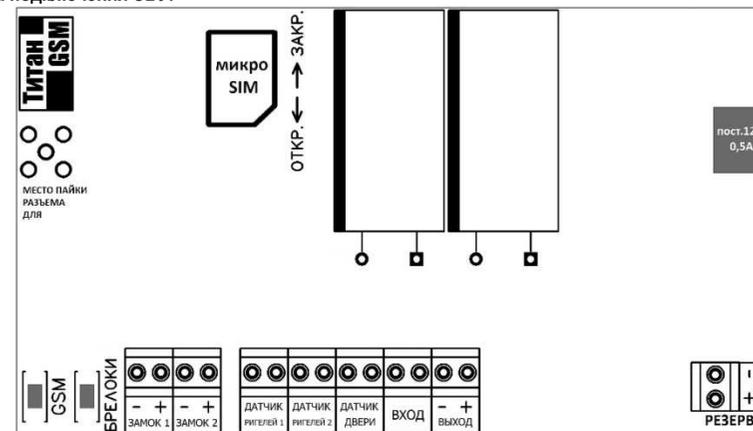
Подключение стандартного ЗП: синий провод от ЗП должен подключаться к клемме ЗАМОК «+», зеленый провод к ЗАМОК «-».
